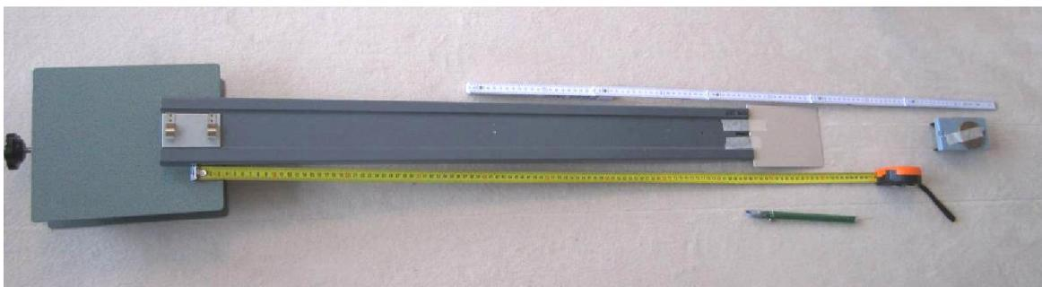
Baue Dir ein Modell einer Runaway-lane gemäß der Abbildung. Die Hebebühne soll auf eine Höhe von max. 9 cm eingestellt werden.
