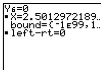
Mit dem Befehl SOLVE (Tastenkombination [ALPHA] [Enter]) wird eine Lösung berechnet.
