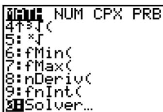
Der Solver... befindet sich im MATH-Menü. Die Gleichung ist in der Form  $T(x) = 0$  einzugeben.
