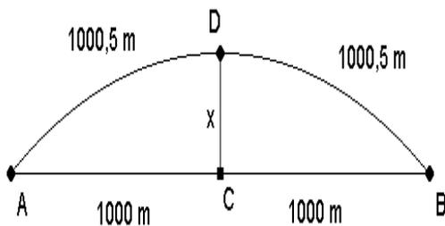
Eine 2 km lange Brücke sei an den beiden Enden unbeweglich „festgemacht“. Bei einem Temperaturzuwachs von etwas mehr als 40° C dehnt sich jeder Meter um ca. 0,5 mm (die ganze Brücke also um ca. 1 m), und die Brücke wird dadurch nach „oben gekrümmt“. Um wie viel wird dabei der höchste Punkt D gehoben?
