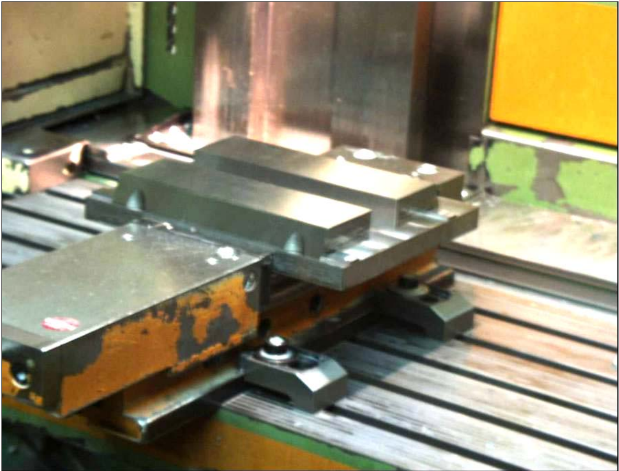
Abb. 8: Rüsten der Werkzeugmaschine, Einsatz der Spannvorrichtung
